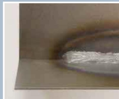
**LAMIERE SOTTILI:** HAC fornisce un arco short morbido e controllato anche ai parametri più bassi con pochi spruzzi, buona bagnabilità dei lembi, riscaldamenti e deformazioni ridotti per saldature di spessori sottili.
