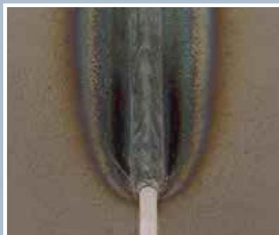
**POSIZIONE PG:** HAC consente la saldatura di lamiere sottili in verticale discendente con separazione fino a 5mm tra i lembi.
