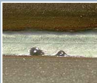
**SPRAY ARC:** HAC consente un arco spray corto con migliore penetrazione al vertice, minore apporto termico, maggiori velocità di saldatura e assenza di incisioni marginali e spruzzi.
