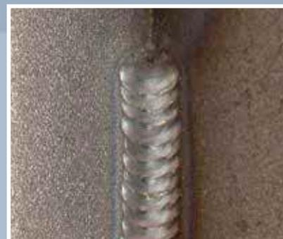
**SALDATURA IN POSIZIONE:** HAC fornisce un arco short con ottima fusione ai margini del cordone che facilita le saldature in posizione sopra-testa e verticale ascendente.
